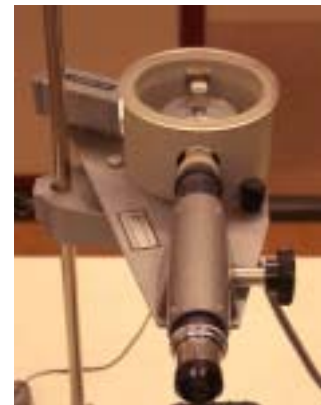
fig 1 - Apparaat van Millikan
