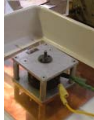
fig. 07 Hier is het trillingsapparaat te zien. De plaat wordt in het midden bevestigd met een schroef en een rubberetje.
