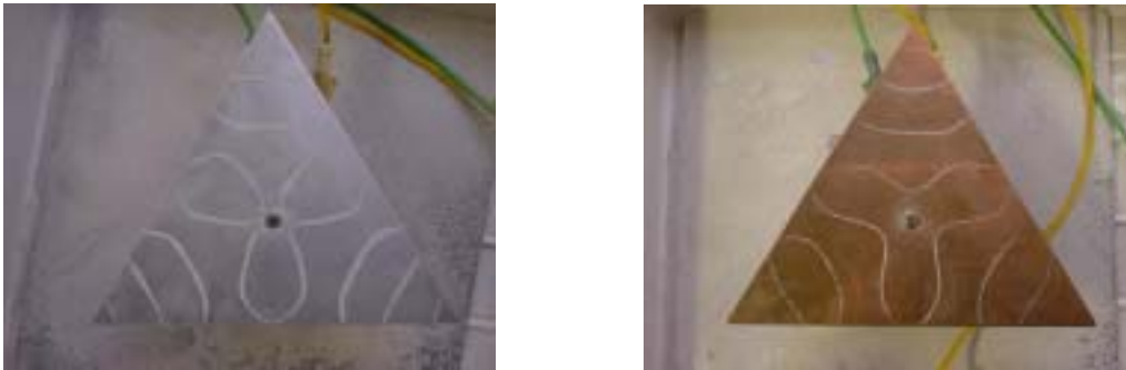
fig. 11 Overeenkomsten in resonantiepatroon tussen de aluminium en de koperen driehoek. De bijbehorende frequenties zijn (v.l.n.r.) 960 Hertz en 3181 Hertz.
