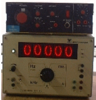
fig. 04 Bovenop staat de pulsgenerator met ingebouwde versterker. Het apparaat daaronder – met de rode nullen – is de frequentiemeter.
