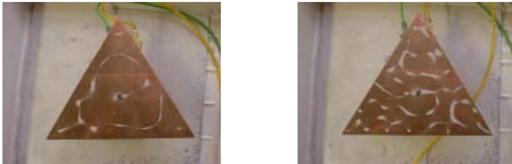
fig. 08 Zwakke resonantiepatronen in de koperen driehoek. De bijbehorende frequenties zijn (v.l.n.r.) 960 Hertz en 3181 Hertz.
