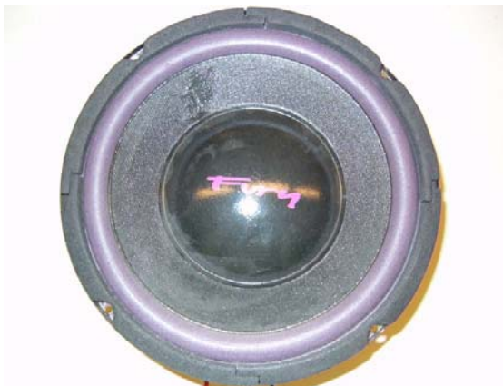
Figuur 1: De subwoofer (8 inch; 200 Watt)
